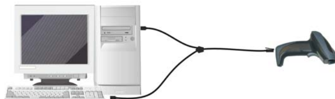
図 3 - キーボードウエッジでの接続例
