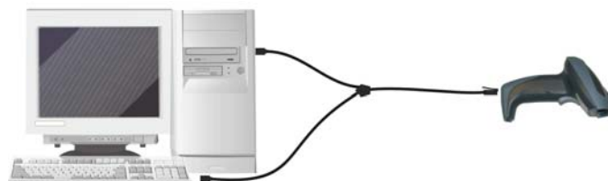
図 3 - キーボードウエッジでの接続例
