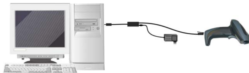
図 2 - USB インターフェイスでの接続例
