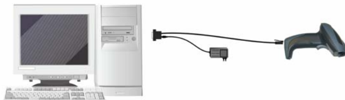
図 1 - RS232 インターフェイスでの接続例
